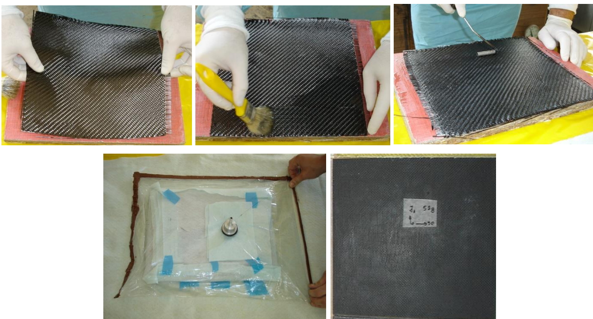
Fig. 2. Realizarea epruvetelor din materiale compozite armate cu fibră de carbon
